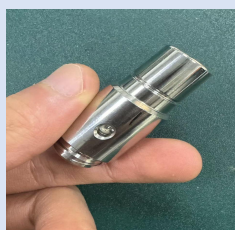
采用不锈钢样品杯侧方预留排气口
