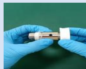
将样品杯安装在样品杯底座上机测试样
