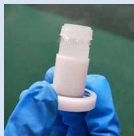
将样品杯拧入样品杯底座
