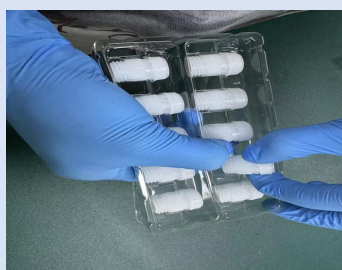
一体化样品杯和测试膜, 无需绷膜及压膜过程
