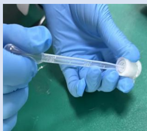
从样品杯尾部硅胶阀切口处注入待测液体
