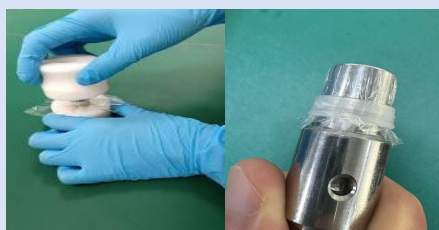
使用工装辅助卡环将测试膜覆盖在样品杯上
